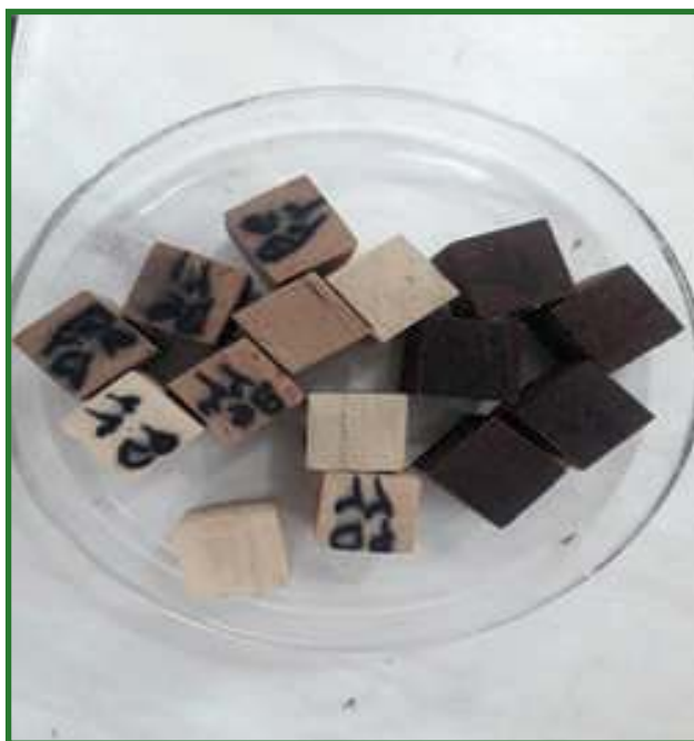
نمونه‌های چوبی تبریزی (نمونه‌های تیره: گرماچوب، نمونه‌های روشن: چوب معمولی)
