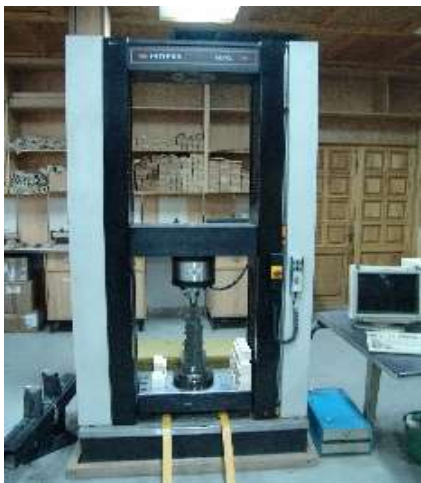
دستگاه آزمایشگر مقاومت مکانیکی اینسترون
