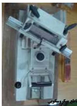
میکروسکوپ پروژکشن برای اندازه‌گیری دقیق ابعاد الیاف
