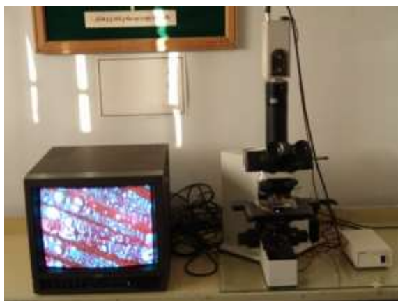
میکروسکوپ پروژکشن با قابلیت اسکن، ذخیره و آنالیز تصاویر
