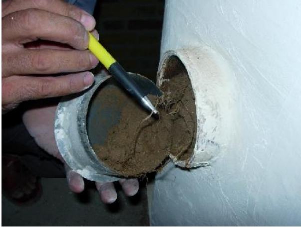
شکل ۶- دریچه‌های نصب شده روی بدنه لایسیمتر برای اندازه‌گیری و مطالعه کیفیت خاک و توسعه ریشه
