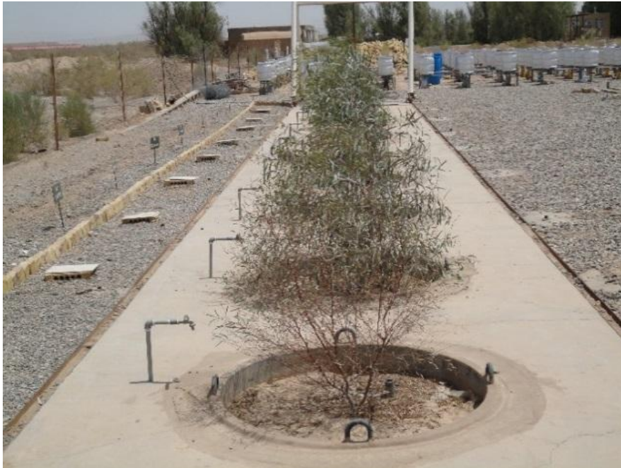
شکل ۱۷- شبکه آبیاری سایت (مجهز به کنتور برای هر لایسیمتر و شیر برداشت آب)
