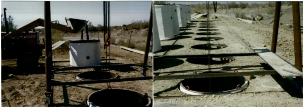
شکل ۱۳- نمای بیرونی محفظه و چگونگی استقرار لایسیمترها روی سکو
