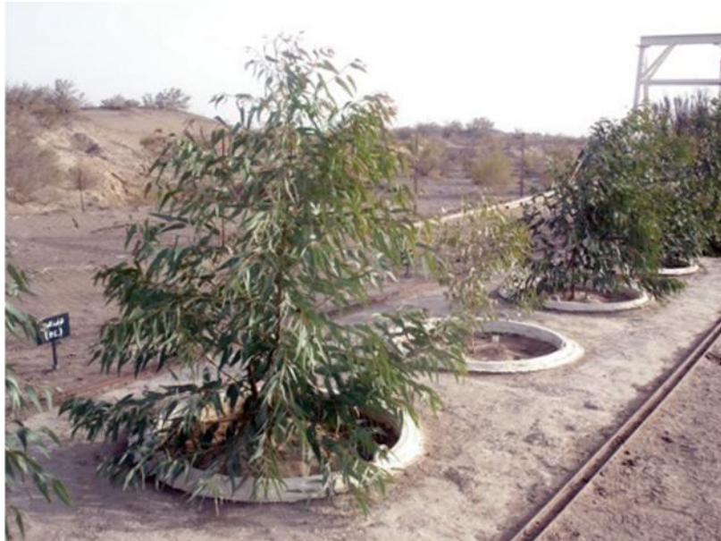
شکل ۱۶- پوشاندن سقف محفظه بوسیله خاک برای کاهش جریان‌های حرارتی افقی از زمین اطراف به لایسیمترها
