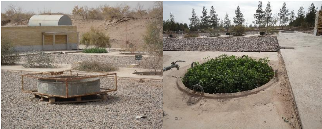
شکل ۱۸- ادوات مربوط به اندازه‌گیری تبخیر تعرق پتانسیل (راست: لایسیمتر مربوط به اندازه‌گیری تبخیر تعرق گیاه مرجع یونجه و چپ: تشتک تبخیر کلاس A)
