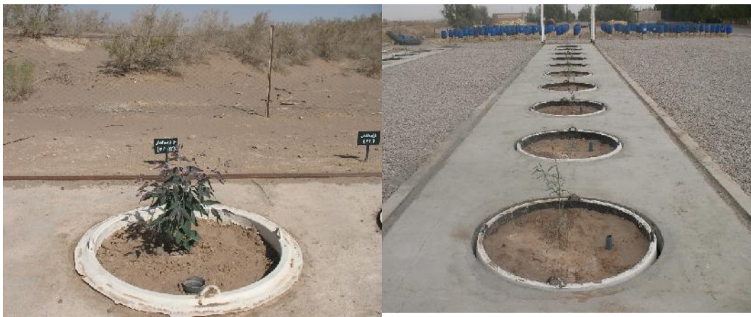
شکل ۱۵- چگونگی استقرار لایسیمترها درون محفظه (راست: قبل از نصب فایبرگلاس روی لبه و چپ: بعد از نصب فایبرگلاس و تماس با سقف محفظه)
