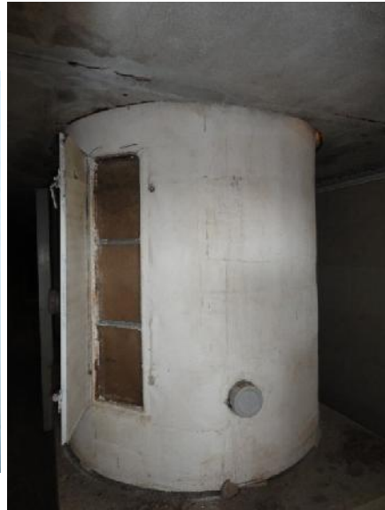
شکل ۶- دریچه‌های نصب شده روی بدنه لایسیمتر برای اندازه‌گیری و مطالعه کیفیت خاک و توسعه ریشه
