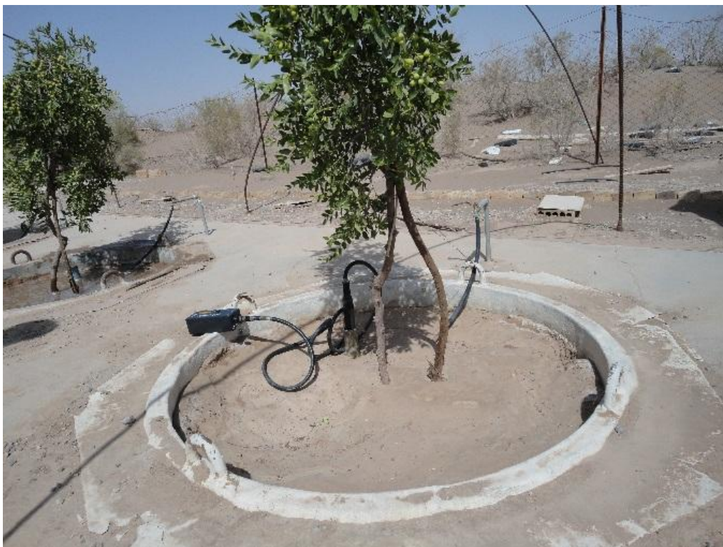
شکل ۸- اندازه‌گیری رطوبت خاک بصورت عمودی در اعماق مختلف بوسیله رطوبت سنج بازتاب زمانی امواج ۶ مدل تراپم
