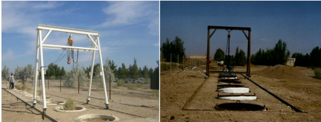
شکل ۱۰- چگونگی کارکرد سیستم توزین لایسیمترها
