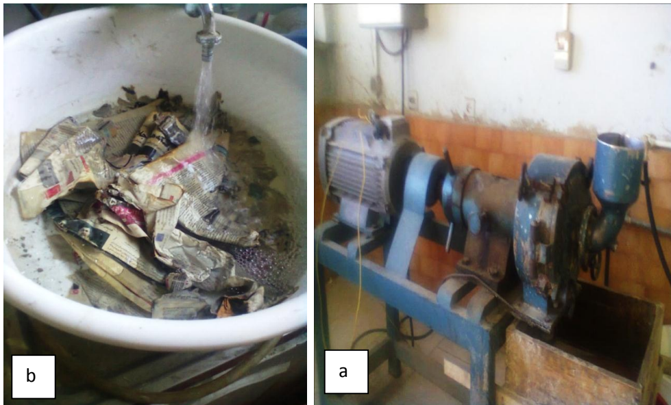
شکل ۱- مراحل تهیه الیاف از روزنامه باطله (a) جداکننده الیاف (b)
